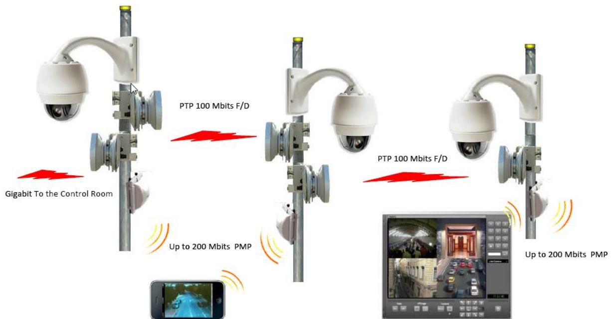
Figure 1.3.1 HyperBridge Wi200-S implementation video & 3-4G offload en topologie anneau.
